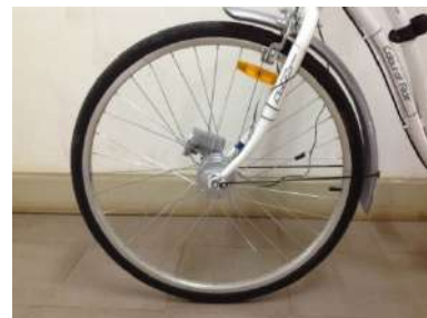
รูปที่ 10 อุปกรณ์ปั่นไฟฟ้า Dyno hub ที่ถูกประกอบเข้ากับรถจักรยานที่ล้อหน้า
