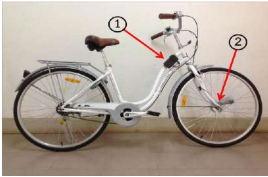
รูปที่ 12 จักรยานปั่นไฟฟ้าต้นแบบเพื่อการอนุรักษ์พลังงาน โดยหมายเลข 1 คือชุดแบตเตอรี่และชุด Regulator และ หมายเลข 2 คือ อุปกรณ์ปั่นไฟฟ้า
