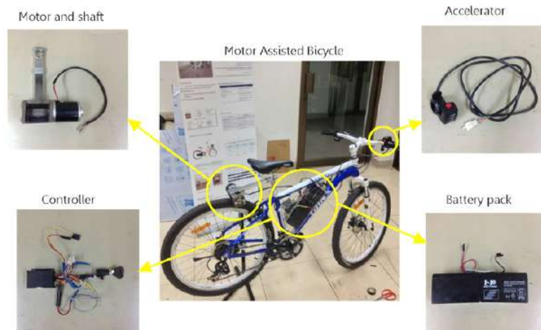
ภาพที่ 3 การประกอบชิ้นส่วนอุปกรณ์ได้แก่ ชุดมอเตอร์ส่งกำลัง (Motor and shaft) ชุดควบคุม (Controller) คันเร่ง (Accelerator) และชุดแบตเตอรี่ (Battery pack)
