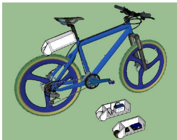
รูปที่ 4 การประกอบชิ้นส่วนอุปกรณ์ได้แก่ ชุดมอเตอร์ส่งกำลัง (Motor and shaft) ชุด ควบคุม (Controller) คันเร่ง (Accelerator) และชุดแบตเตอรี่ (Battery pack)
