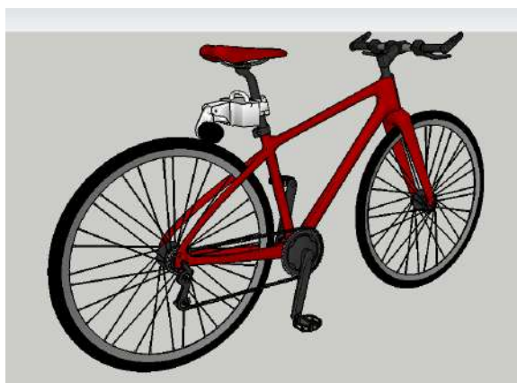
รูปที่ 5 การประกอบชิ้นส่วนอุปกรณ์ได้แก่ ชุดมอเตอร์ส่งกำลัง (Motor and shaft) ชุด ควบคุม (Controller) คันเร่ง (Accelerator) และชุดแบตเตอรี่ (Battery pack)
